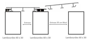
Le clip de fixation permet à la fois de venir bloquer la lame sur la lambourde mais aussi de définir automatiquement un espacement de 5mm entre 2 lames.
