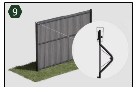
9 Emboîtez une lisse haute en respectant le sens de pose par rapport à la réglette puis répétez l'opération pour la seconde lisse
