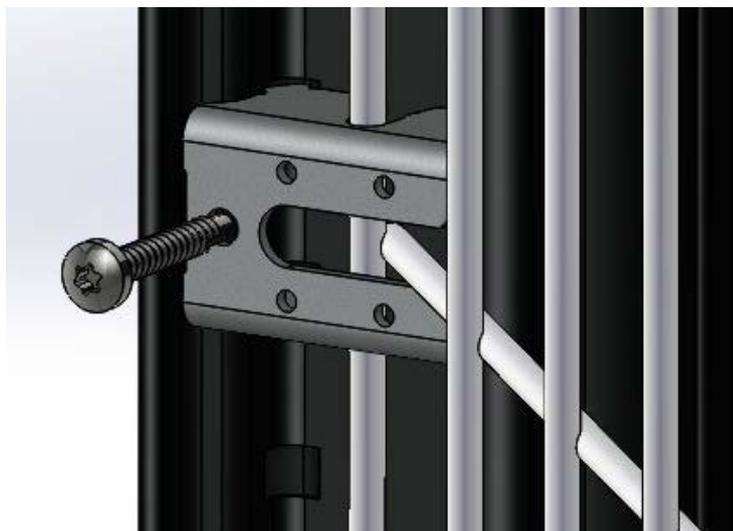
Le verrouillage par vis autoforreuse lors de la pose en angle du clip est obligatoire.
